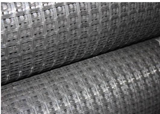
Сетка кладочная «БЕНСТЕН К» представляет собой две системы базальтовых или стеклянных ровингов, расположенных перпендикулярно по отношению друг к другу, провязанных между собой третьей – провязывающей полиэфирной нитью и пропитанных полимерными дисперсиями.
